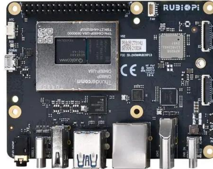
Rubik Pi 3 SoC: QCS6490 CPU: Cortex-A78x4 + Cortex-A55x4 GPU: Adreno GPU 643 NPU: 12 TOPS Memory: LPDDR4 8GB OS: Ubuntu 24.04
